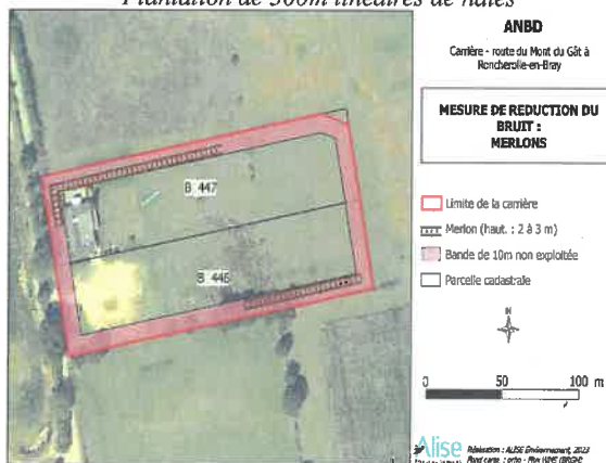
Création de merlons anti-bruit en phase d'exploitation
